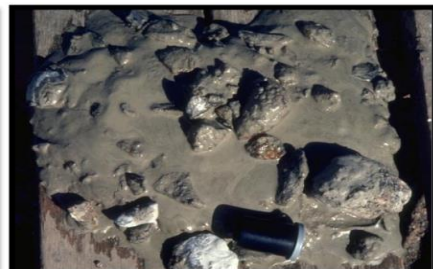
Thawed gravelly silty sand till
