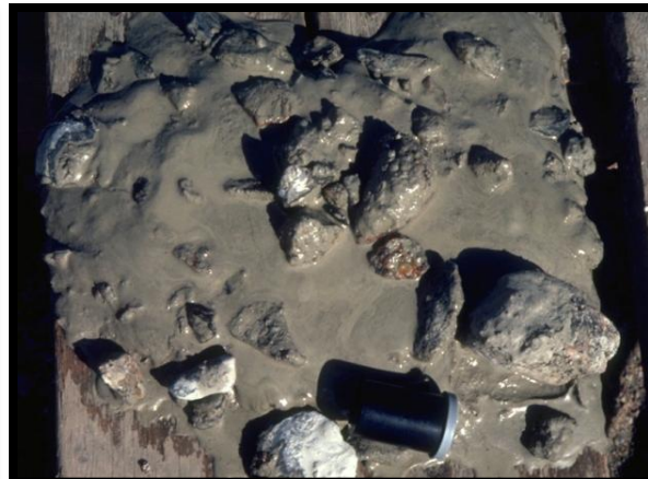
Thawed gravelly silty sand till
